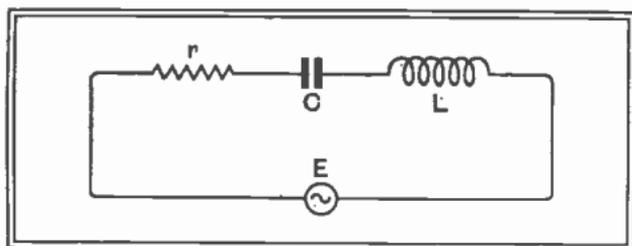
Fig. 49 : Series-tuned circuit : if  $L=200\mu\text{H}$ ,  $C=200\mu\mu\text{F}$ ,  $r=10$  ohms, the magnification will be 100 at resonance. (See Fig. 50)
