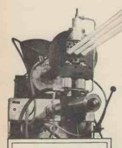
TRIPLE EXTRUSION OF PTFE ROD
