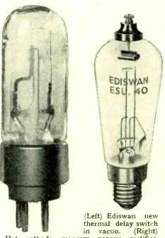
Hot cathode mercury vapour rectifier.
