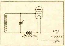
Fig. 1.—A simple way of providing a bias of 0.5 volt.
