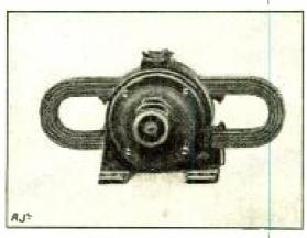
Fig. 4.—Bethenod Magneto-Alternator
