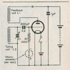
FIG. 3. A SIMPLE OSCILLATOR
