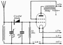
Fig. 2.-A diode-valve circuit.
