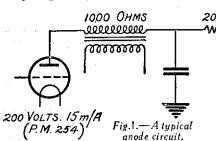
Fig.1.-A typical anode circuit.
