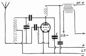
Fig. 213.—The Hartley Circuit.
