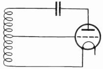
Fig. 55.-Autodyne Circuit.
