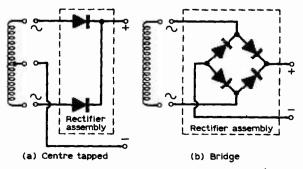
Fig. 10: Basic rectifier assemblies.
