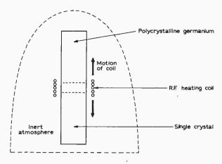
Fig. 4: Float zoning apparatus.
