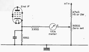
Fig. 8: The S-Meter circuit.
