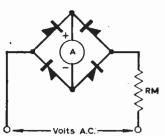
Fig. 1: The basic rectifier voltmeter bridge.
