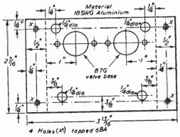
Fig. 4.—The A.F. chassis.
