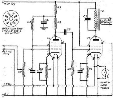
Fig. 7.-Amplifier circuit.
