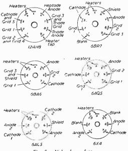
Fig. 5.--Valve base data.
