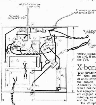
Fig. 3.-Practical wiring diagram.
