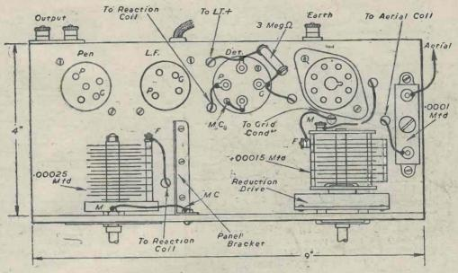
Fig. 2.- Top of chassis layout.
