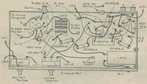
Fig. 3 .- Sub-chassis wiring diagrams.
