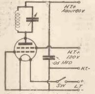
Fig. 1 .- The "Autodyne" circuit.
