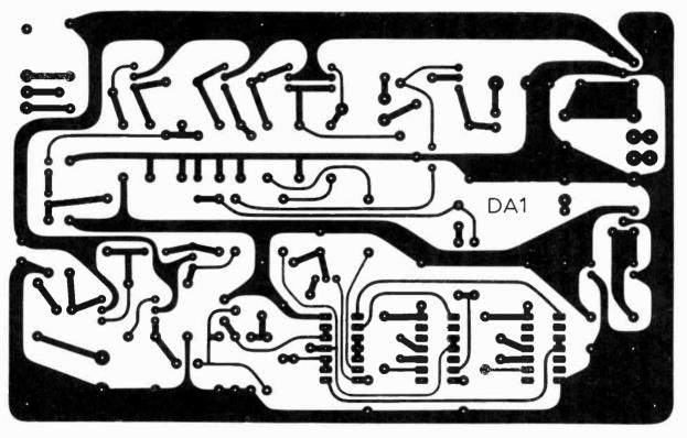
Fig. 3: PCB print pattern. Shown actual size.
