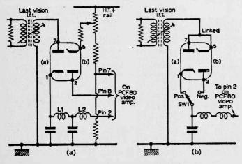
Fig. 1-Switchable diode detector (valves).
