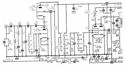
Fig. 1-V.H.F. tuner unit.
