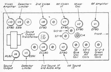
Fig. 4.—Chassis layout.
