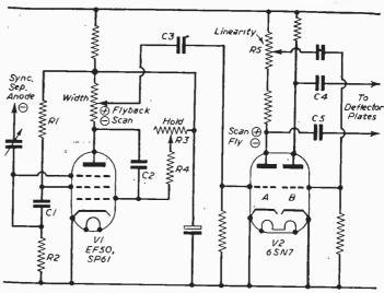
Fig. 50.—Time base and output circuit.
