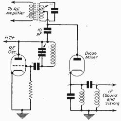
Fig. 3.-Diode Mixer Circuit.
