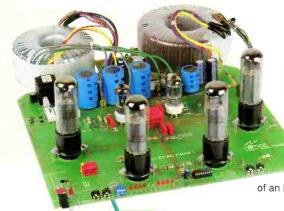
**MONO VALVE POWER AMPLIFIER MODULE 90WRMS**
