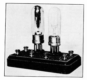
Fig. 1. The rectifier panel.
