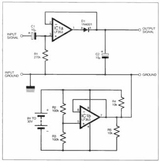
Fig.2. A.C. ripple active rectifier.
