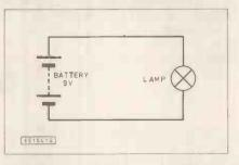
Fig. 1.7. Circuit diagram for Fig. 1.7.
