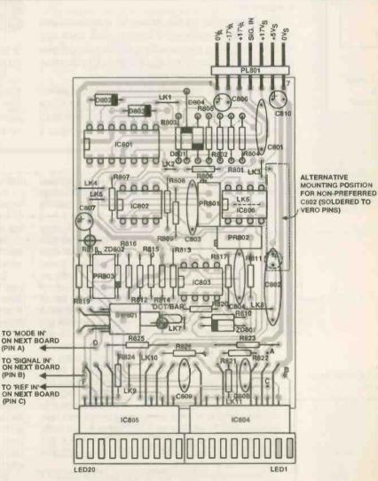
COMPONENT OVERLAY FOR PEAK PROGRAMME METER (LINK 11 INSERTED; LOWERMOST BOARD IN CASCADED SERIES OR SINGLE, STAND-ALONE BOARD)
