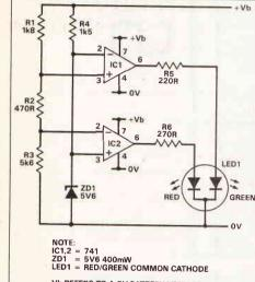
Vb REFERS TO A 9V BATTERY VOLTAGE Vb < 7V3 LED1 IS RED Vb > 7V3 AND Vb < 8V0 LED1 IS YELLOW Vb > 8V0 LED1 IS GREEN
