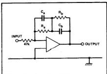
Fig. 3 A series-feedback equalisation arrangement.
