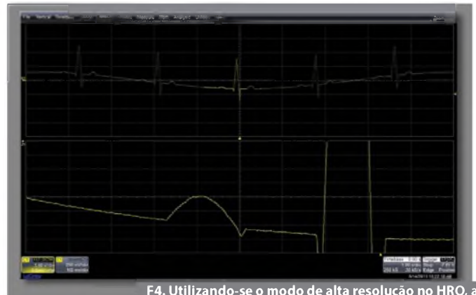
F4. Utilizando-se o modo de alta resolução no HRO, a forma real do sinal subjacente pode ser agora vista.
