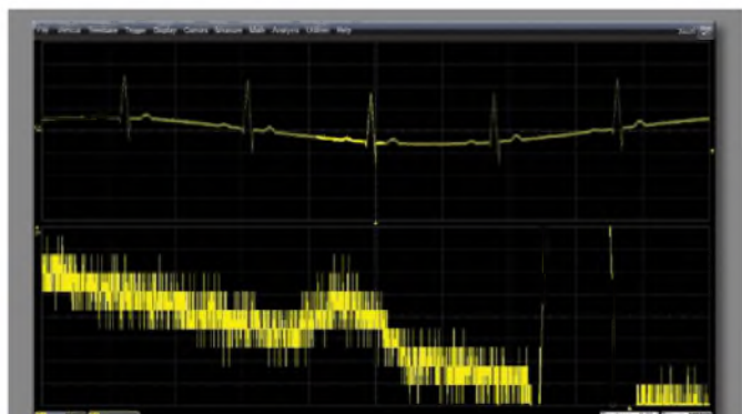
F1. O traço superior é um sinal de um gerador de forma de onda arbitrária e captado por um osciloscópio. O traçado inferior é um detalhe ampliado da porção destacada do traço superior.
