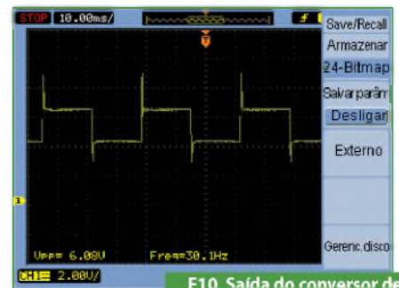
F10. Saída do conversor de frequência para 30 Hz.
