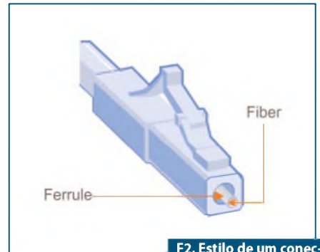
F2. Estilo de um conector ótico LC.
