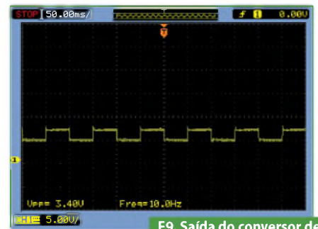
F9. Saída do conversor de frequência para 10 Hz.
