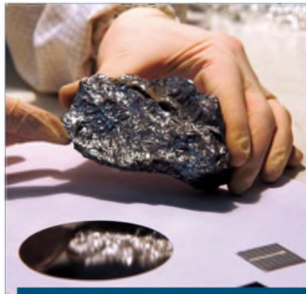
F2. O Silício metalúrgico (acima), a lâmina (à esquerda) e as células solares (à direita).
