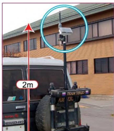
F3. Instalação da unidade-servo (móvel) na traseira de um carro em uma altura de 2m.
