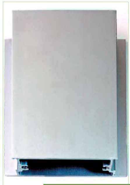
F12. Eletrocalha de alumínio usada como gabinete.
