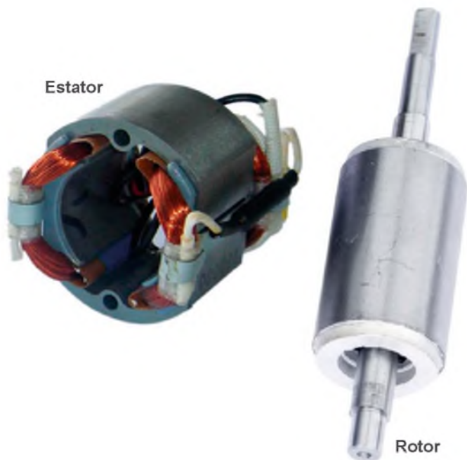
F2. Estator e rotor do motor assíncrono trifásico.
