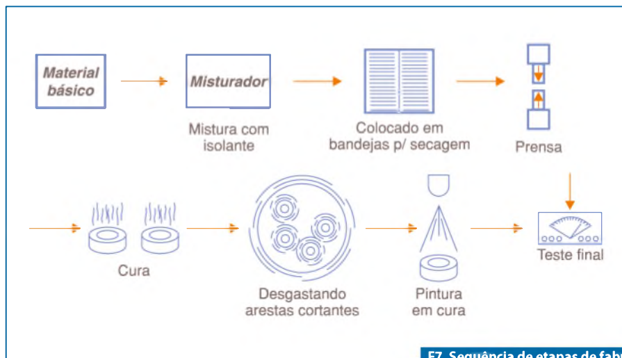
F7. Sequência de etapas de fabricação de núcleo de Fe rm pó.
