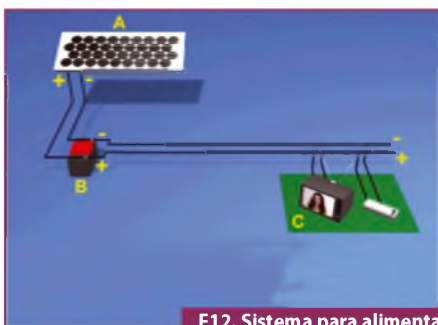
F12. Sistema para alimentar equipamentos residenciais.
