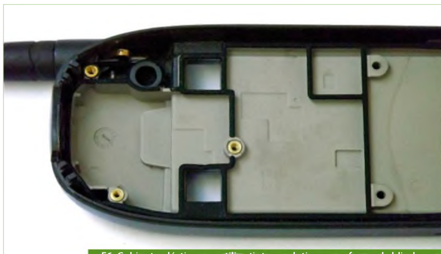
F6. Gabinete plástico que utiliza tinta condutiva como forma de blindagem.
