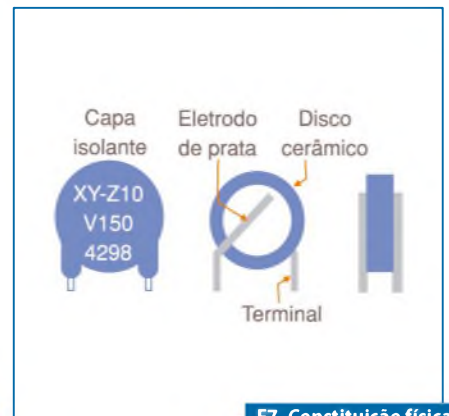
F7. Constituição física do varistor.
