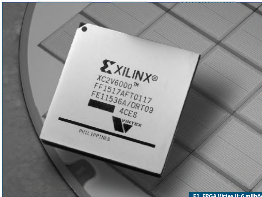
F1. FPGA Virtex II: 6 milhões de gates e 1517 pinos.
