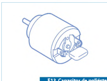
F13. Capacitor de poliéster contra ruído no motor.
