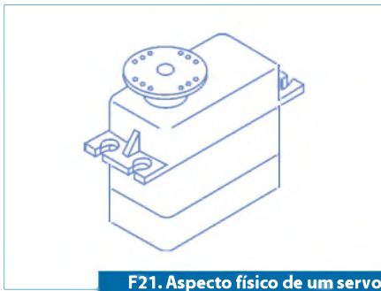
F21. Aspecto físico de um servo.
