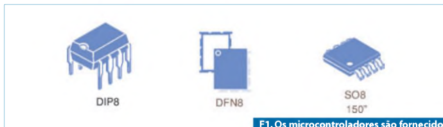
F1. Os microcontroladores são fornecidos em três invólucros diferentes.
