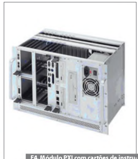
F4. Módulo PXI com cartões de instrumentos para instalação em rack 19.
