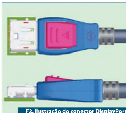
F3. Ilustração do conector DisplayPort para conexões externas.
