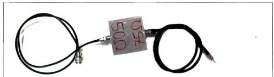
F2a. Antena dummy para interligar a saída do gerador de RF (cabo à esquerda) com a entrada de antena do auto-rádio (cabo à direita)
