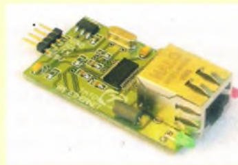
BASIC Ethernet - adaptador serial para ethernet, permite qualquer microcontrolador acessar a Internet, enviar e-mails, etc
