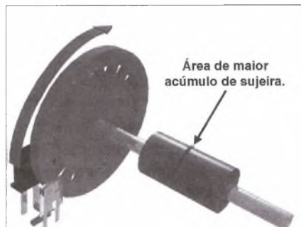
Fig. 9 - Áreas de maior acúmulo de sujeiras, que prejudica o bom funcionamento do mouse.
