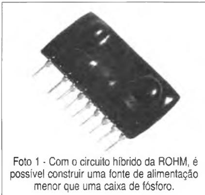
Foto 1 - Com o circuito híbrido da ROHM, é possível construir uma fonte de alimentação menor que uma caixa de fósforo.
