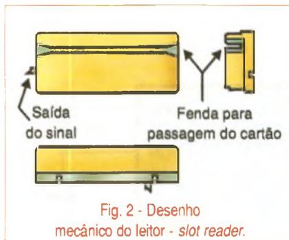
Fig. 2 - Desenho mecânico do leitor - *slot reader*.
