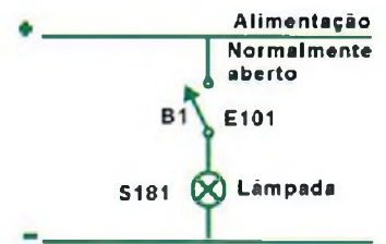
Fig. 7 - O circuito de acionamento do CLP
