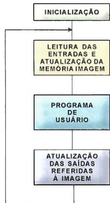
Fig. 5 - Representação do ciclo de varredura dos CLPs
