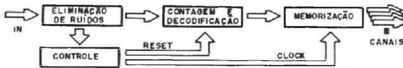
Fig. 5 — Diagrama de blocos do Módulo Decodificador de 16 canais.
