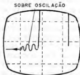
Fig. 13 — Aumentando o ganho para observar pormenores de um pulso.
