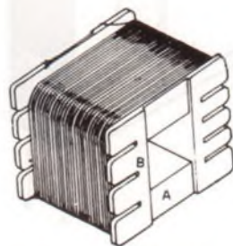
Fig. 6 — Como medir o núcleo do carretel.
