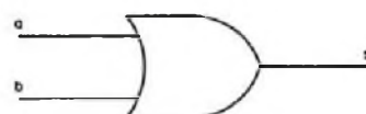
Figura 12 – Símbolo do operador OU ou OR de duas entradas a e b.
