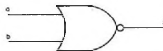
Figura 13 – Representação gráfica para o operador lógico NOU ou NOR de duas entradas.
