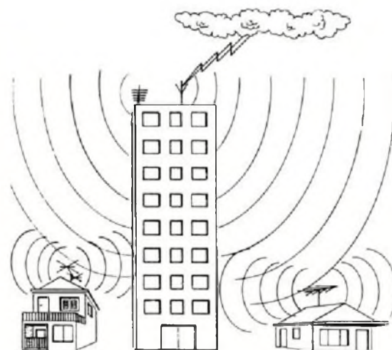
Indução de antenas e condutores elétricos, causada por um raio que caiu nas proximidades.
